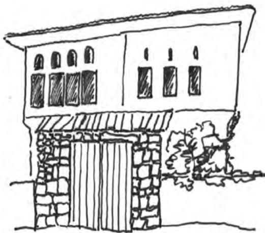
تصویر ۳ و ۴ - سمت چپ: تقسیم عمودی یک ساختمان در آناتولی به نیمه زمستان (راست) با پنجره‌های کوچک و نیمه تابستان (چپ) با دهانه‌های بزرگ‌تر. منبع: (Küçükerman, 1996)، سمت راست: عناصر سایه‌انداز در سبک عثمانی در تسالونیکي توسط کرکره (سمت راست در تصویر) آویزان شده اند. منبع: (Moutsopoulos, 1979)
